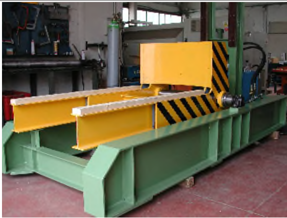
Ribaltatore per "pizze" di lamiera Inox \varnothing max 1.800mm - Hmax 500mm - Pmax=4.500 daN
