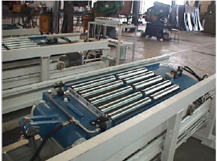
Sformatore semiautomatico per linea di produzione manufatti ceramici
