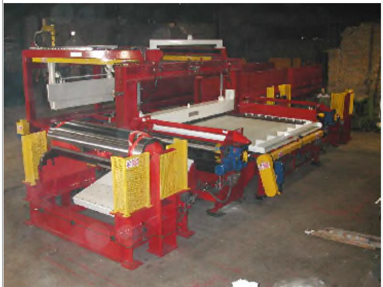
Linea di produzione lamierini presso-piegati con prelievo da coil, taglio a misura, piega e trasferimento a linee di alimentazione pieghettatrice/plissettatrice
