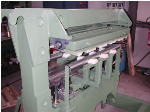
Attrezzatura di piega cupolini di copertura in lamiera sagomata
