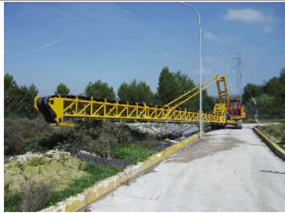
Applicazione di nastro trasportatore lungo 20 mt all'attacco di uno scavatore cingolato commerciale per lo spargimento fanghi in discarica
