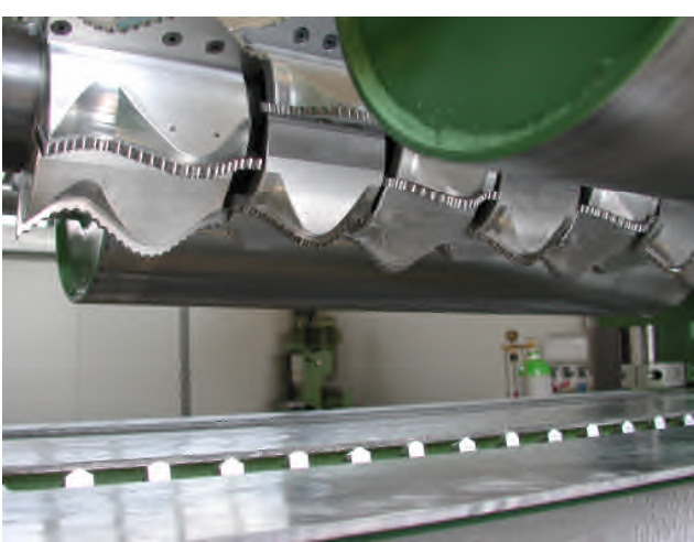
Esempio di realizzazione di una FRESATRICE A SAGOMA per pannelli di Polistirolo
