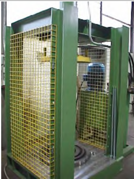
Pressa verticale con stampo per la realizzazione della bordatura a "riccio" su linea di produzione fusti in lamiera atti al trasporto di merci pericolose
